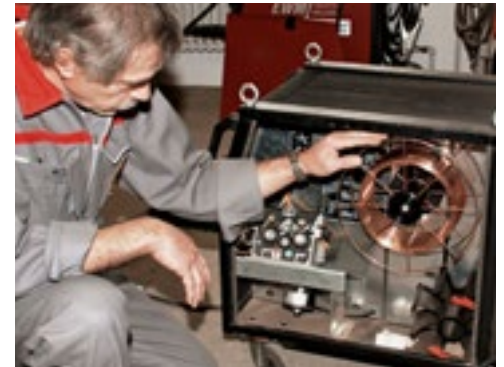
Blick ins Innere des Schweißgeräts mit dem Drahtvorschubmechanismus.
